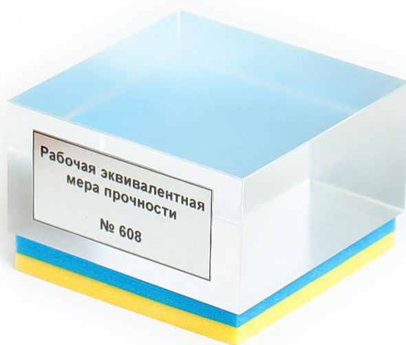
Рисунок 2 – Внешний вид рабочей эквивалентной меры прочности из оргстекла
