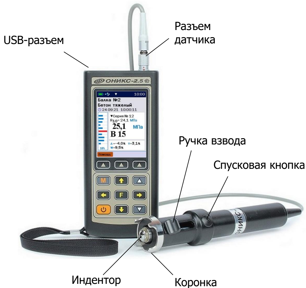
Рисунок 1 – Внешний вид прибора модификации «ОНИКС-2.5»
